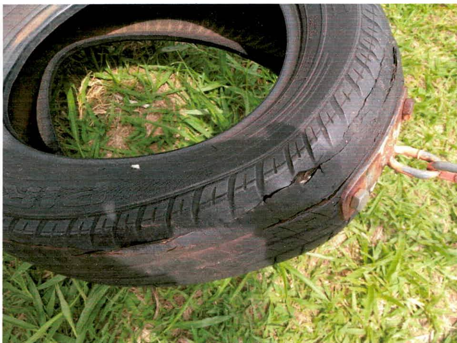
Figura 1 - Ponto de fixação deteriorado no balanço de pneu.
